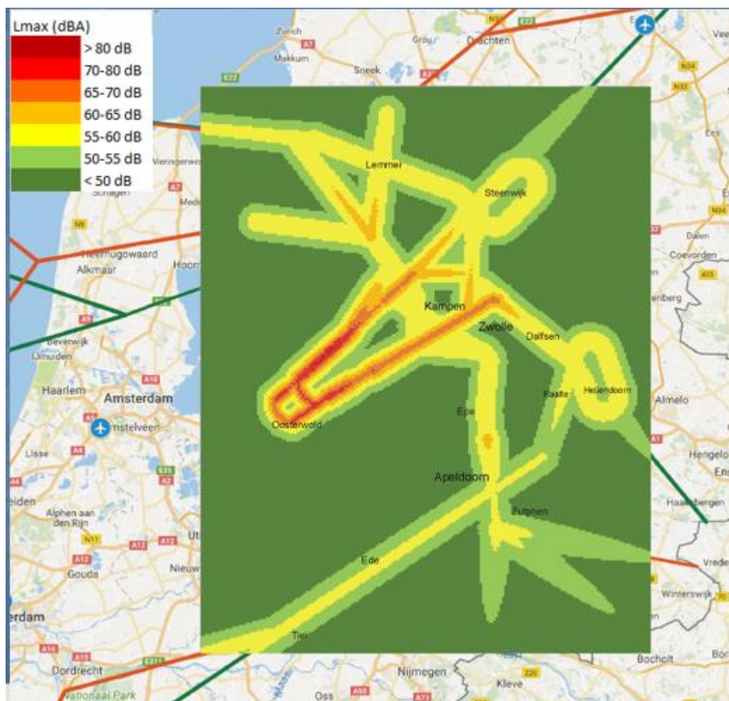
Figuur 14 Piekniveaus berekend door HoogOverijssel. De gele band is de zone van 55 tot 60 dB. Onder deze band zullen piekniveaus 15 dB of meer zijn dan het achtergrondgeluid, en daarmee aanleiding geven tot ernstige hinder en slaapverstoring.
